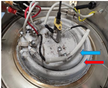
מיחם בעל שני גופי חימום – גוף החימום הגדול מיועד להרתחה ומסומן בחץ אדום, והקטן מיועד לשמירת חום ומסומן בחץ
